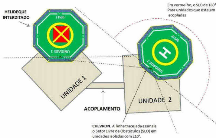
fig. 3 - acoplamento com SLO de 210° (helideques 1 e 2 interditados); com SLO de 180° (helideque da Unidade 1 interditado)
